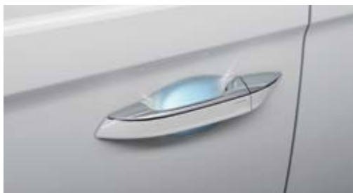
Podświetlane klamki zewnętrzne z dwukanałowym czujnikiem dotykowym
