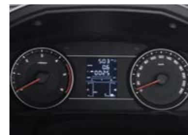
Zestaw wskaźników z 3,5" wyświetlaczem komputera pokładowego
