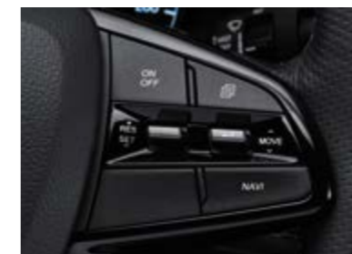
Przyciski sterowania tempomatem i komputerem pokładowym w kierownicy
