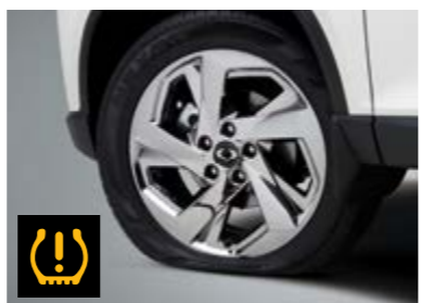
System kontroli ciśnienia w oponach (TPMS)
