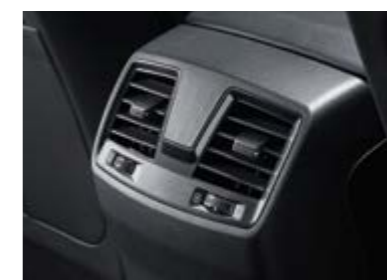
Nawiew klimatyzacji na 2-gi rząd siedzeń
