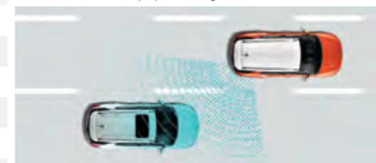
LCA/BSA – system ostrzegający o pojazdach w martwym polu
