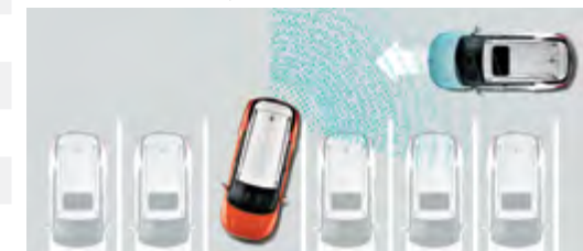
RCTA – radar ruchu poprzecznego
