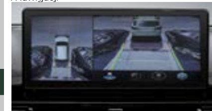
System kamer 360 stopni)
