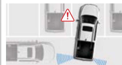
RCTA System monitorowania ruchu za pojazdem z asystentem
