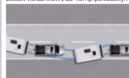
TSC - System kontroli kołysania przyczepy
