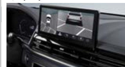
System kamer 360 stopni
