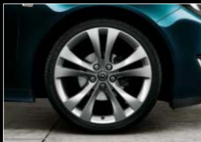
Obręcze kół ze stopów lekkich 20 x 8,5" 5-ramienne podwójne, polakierowane wielowarstwowo, opony 245/35 R 20 (RTH)
