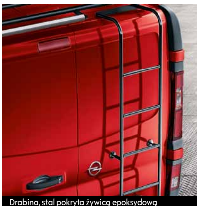
Drabina, stal pokryta żywicą epoksydową
