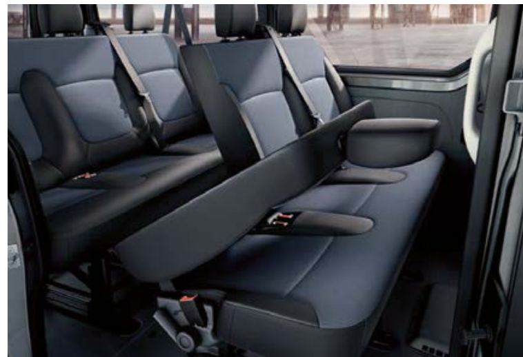
OPARCIE DRUGIEGO RZĘDU SIEDZEŃ SKŁADANE W PROPORCJI 60/40. Pasażerowie tylnej kanapy zyskują ułatwiony dostęp do drzwi bocznych.
