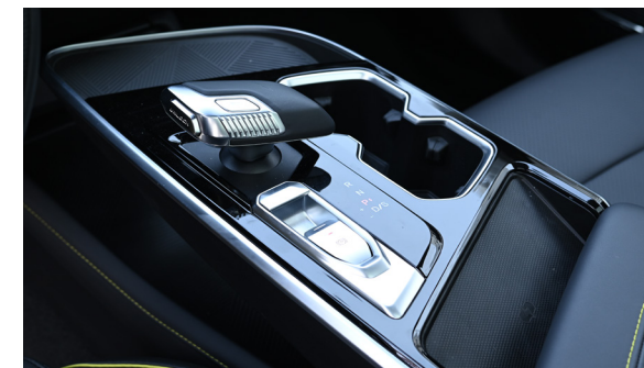
Elektroniczne sterowanie automatyczną skrzynią biegów 7DCT
