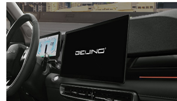
Dotykowy ekran multimedialny na środkowej konsoli o przekątnej 10,1 - cala
